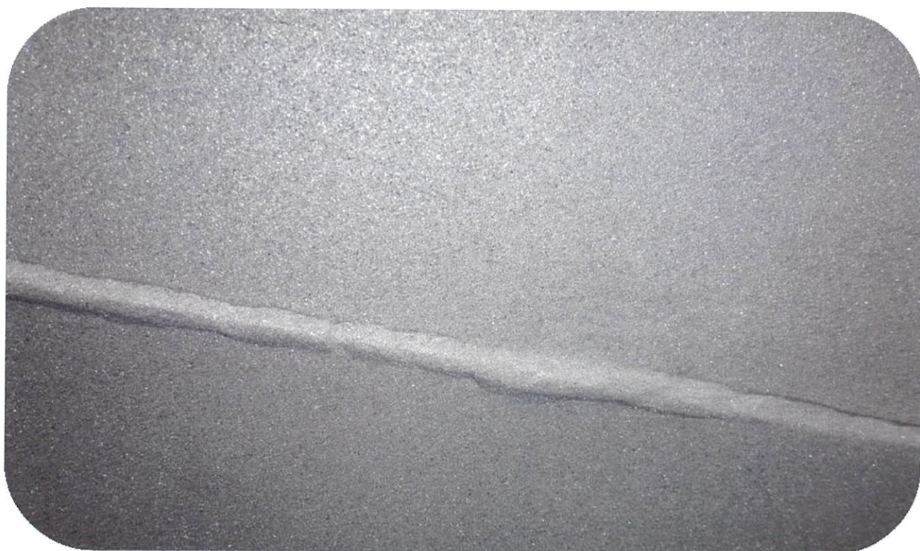
ブラックグリット#5ブラスト拡大写真(表面の付着が少ない)
