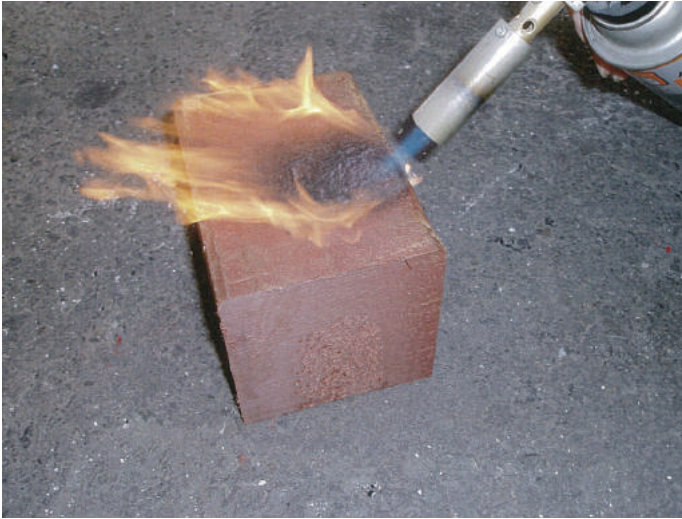
人工木燃焼試験状況(難燃グレード) Artificial wood fire test conditions
