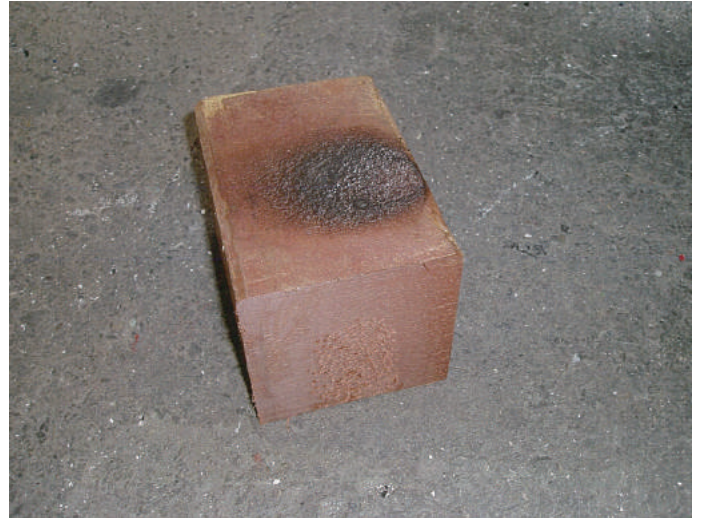
人工木燃焼試験状況(難燃グレード) Artificial wood fire test conditions
