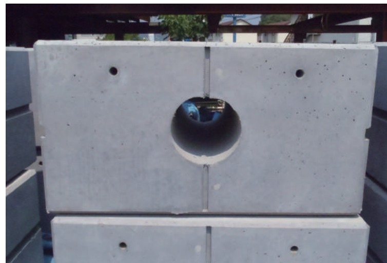
コンクリート盤木製作状況(丸穴はレベル確認用) Concrete Artificial wood board production situation(Round hole is for level check)
