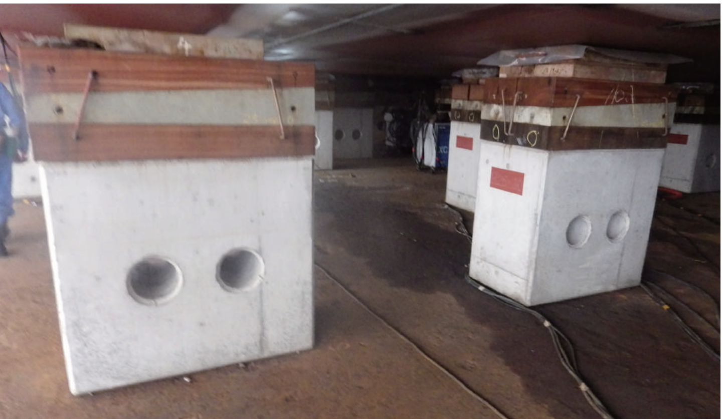
新造船における人工木と天然木併用使用状況 Situation that combination of natural wood and artificial wood for New shipbuilding
